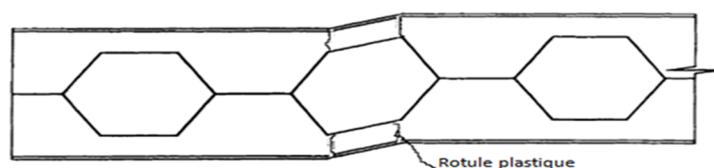
**Figure IV.1:** Mécanisme de ruine par flexion Vierende el [17]
