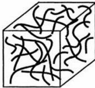
Figure (I.1) : composite à renforts de fibres [3]
