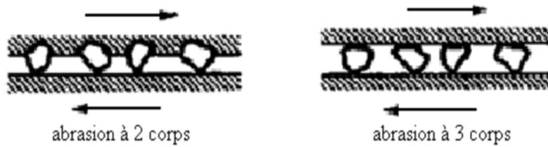
Figure 2.14 : Représentation schématique de l'usure abrasive à 2 corps et à 3 corps [27]
