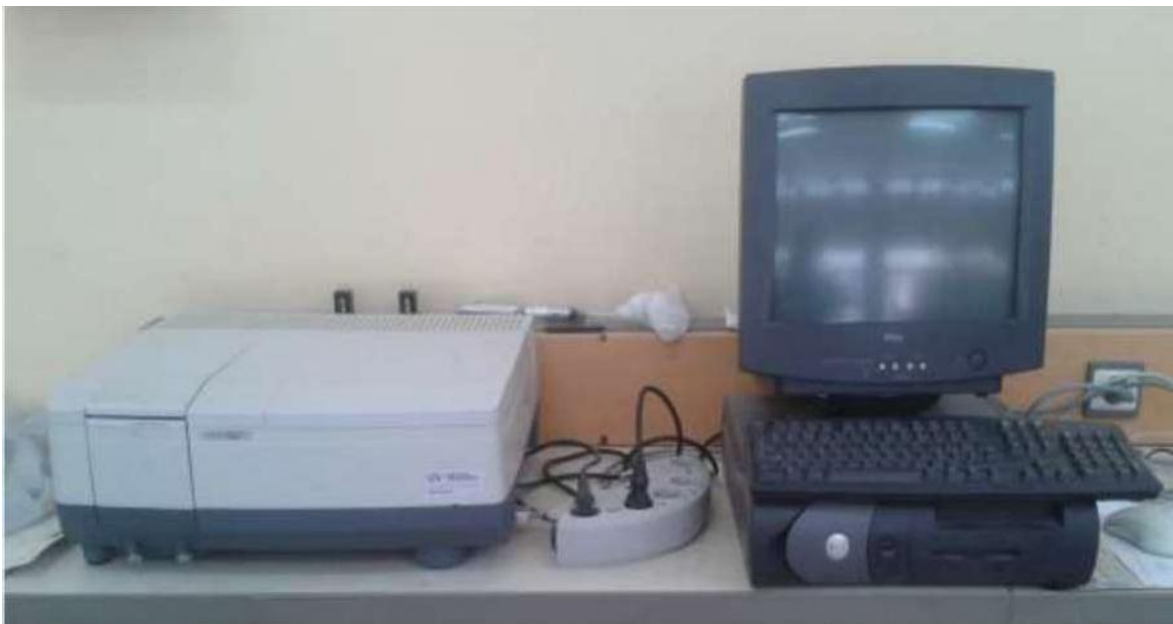
Figure II.5 : Schéma de Spectro photomètre à double faisceau de type SHIMADZU (UV1650 PC).
