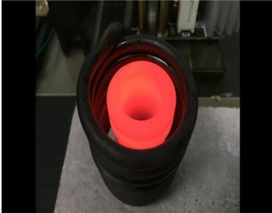
**Figure II.6 :** Fonderie a la chauffe par induction
