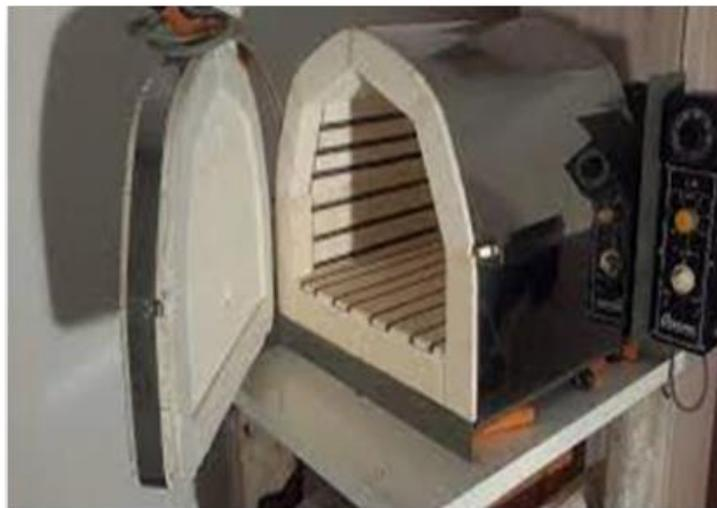
**Figure II.3** : Fours électriques à résistances
