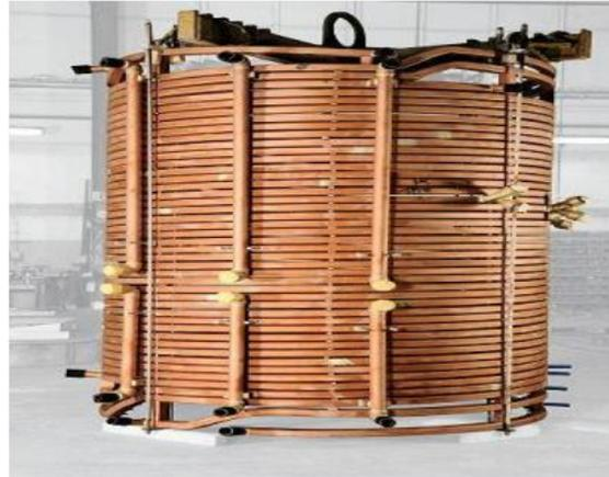
**Figure II.5 :** Isolation de bobine de four à induction.
