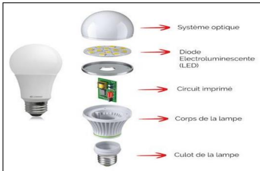
Figure II.15 : Schéma qui déterminer les constituant de lampe LED
