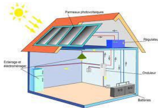
Figure II.15 : Installation sur site isolé
