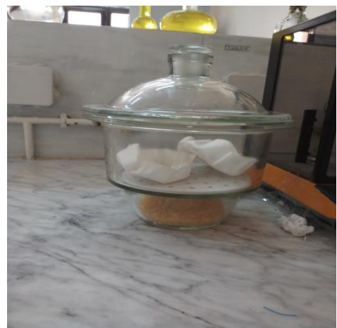
Elimination de l'humidité dans le dessiccateur
