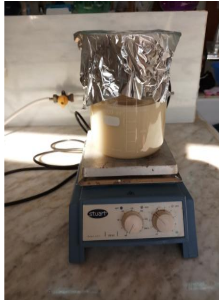
Agitation de la suspension argileuse
