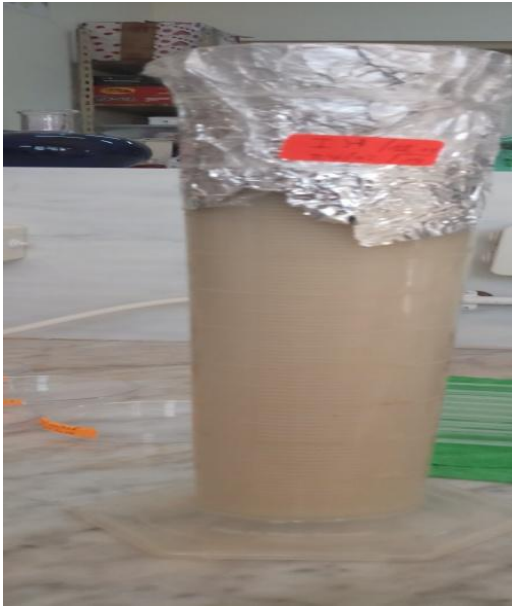
solution argileuse dans une éprouvette de 1L.
