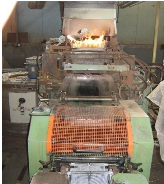
Figure 2.3 : Aperçu d'une fondeuse.
