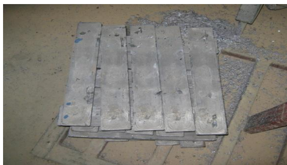
Figure 2.4 : Aperçu des lingots en plomb.
