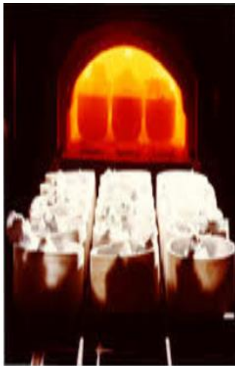
Figure. II. 7 : La calcination (cuisson) de la pierre (calcaire)
