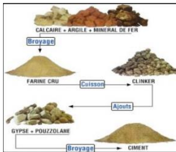
Figure. II. 2 : Processus de fabrication de ciment
