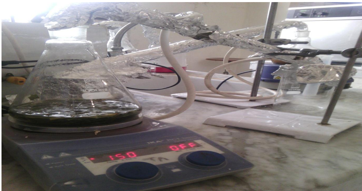
Figure 1.2 : Montage de l'hydrodistillation (Originale).
