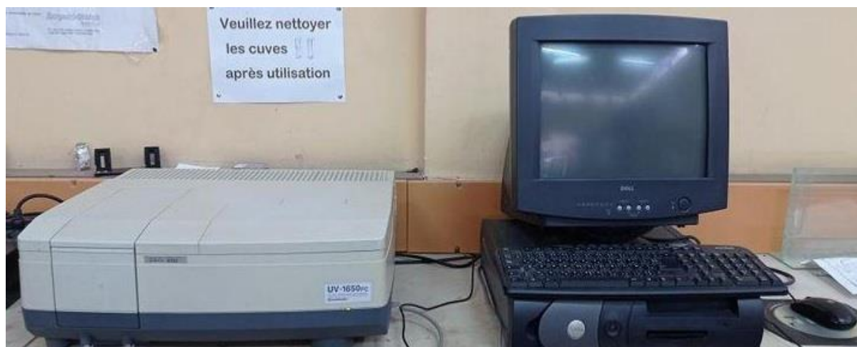
Figure III.11. Schéma de photomètre à double faisceaux de type SHIMADZU (UV 1650PC)
