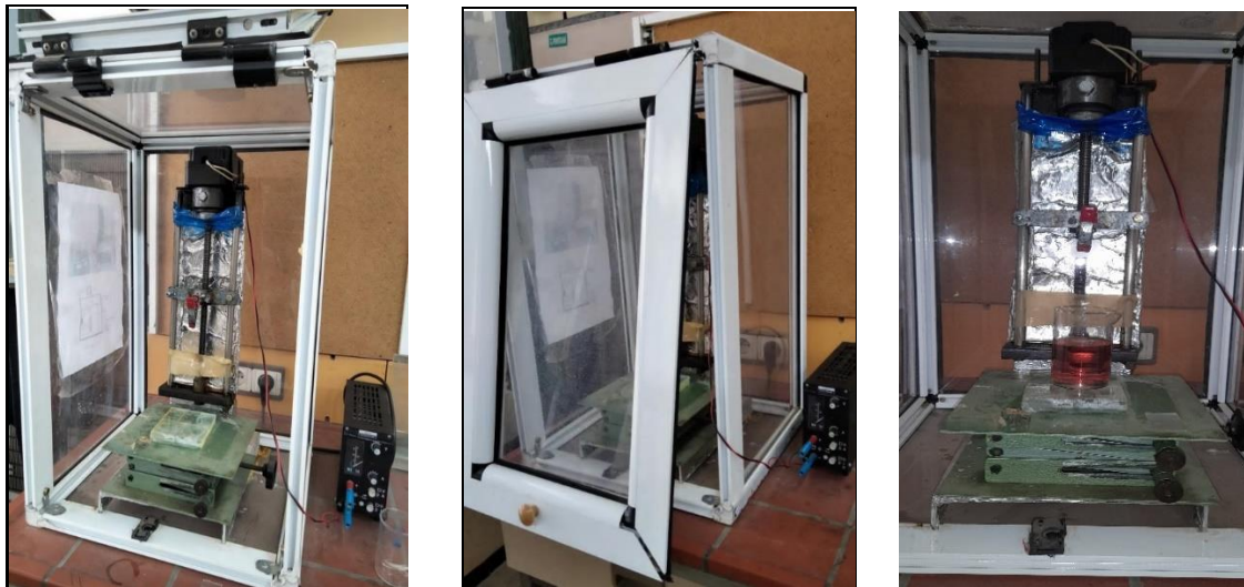
Figure III.6. Dispositif expérimental de trempage-tirage « Dip-Coating »
