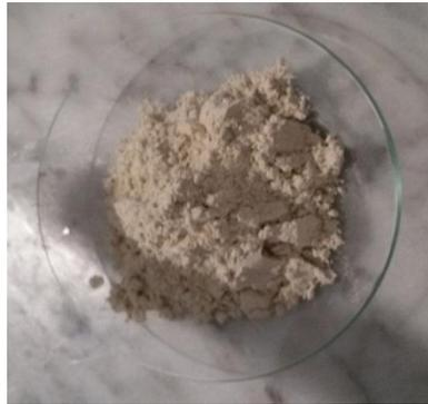
**Photo 15** : préparation du suspension d'argile 20g d'argile dans 1L d'eau distillé
