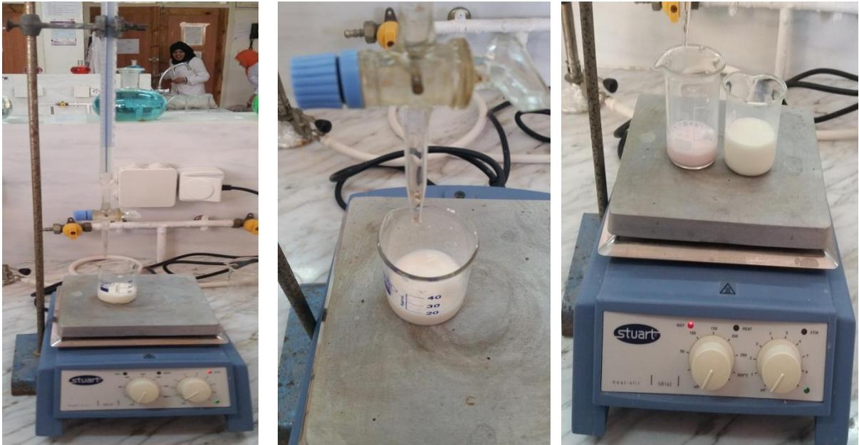
Photo 24 : détermination de l'acidité dornic du lait.
