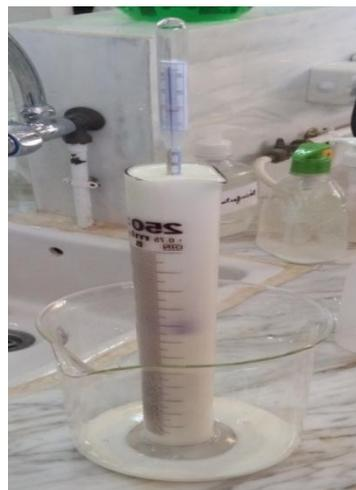
**Photo 23**: détermination de la densité du lait.
