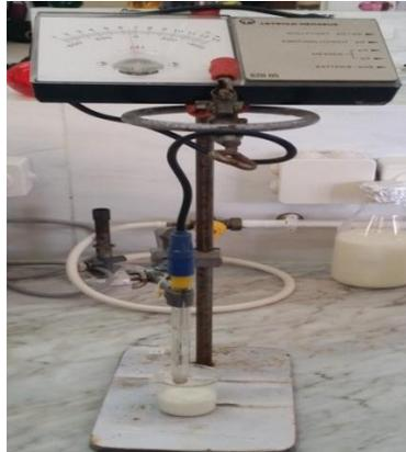
**Photo 22** : mesure de pH du lait.
