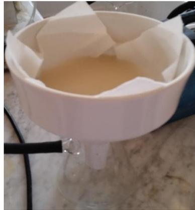
**Photo 18:** filtration du 50ml de la suspension d'argile a l'aide d'une pompe à vide.
