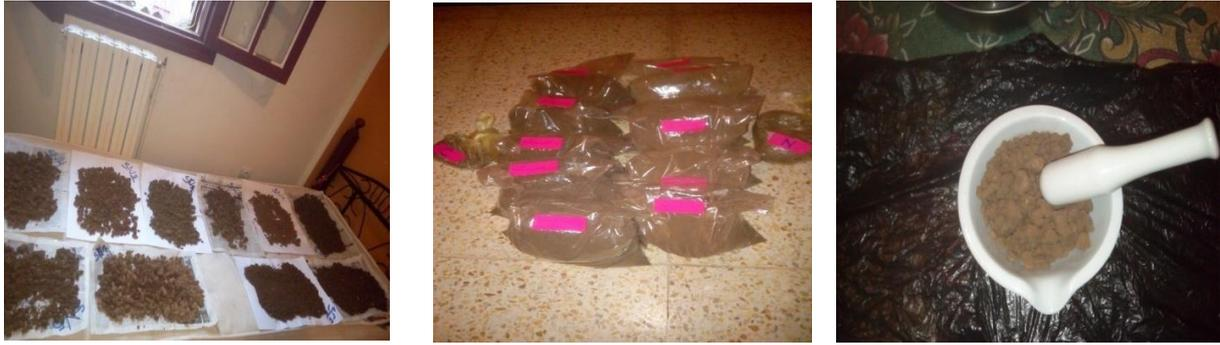
**Figure N°10 :Préparation des échantillons ; séchés ; conservés et tamisés**
