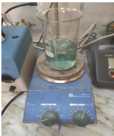
Figure N°11 : Titrage par le sel de Mohr.
