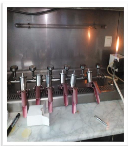
- Rampe de filtration
