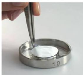
5. Placez la bague porte-substrat à sa place. Prenez la bague de support du substrat dans la pointe de l'outil de positionnement du substrat et enfoncez-la jusqu'à ce qu'elle cliquât à sa place. Vérifiez que le substrat de la collecte est en douceur à sa place.
