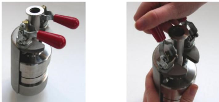
Avant d'assembler, n'oubliez pas de mettre les supports de collecte sur les plaques de collecte des frappeurs. Il est recommandé que les substrats de collecte sur les plaques d'impaction soient graissés pour éviter le rebond des particules (**Dekati, 2012**).
