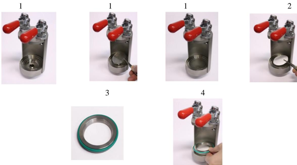
L'assemblage se fait dans l'ordre inverse pour le démontage. Vérifiez que chaque étage de frappe comporte les pièces suivantes: plaque de jet, bague d'espacement, ressort en métal et plaque de collecte. Vérifiez que chacune des plaques à jet a un joint torique des deux côtés de la plaque et insérez le ressort métallique sur le dessus de la bague d'espacement.
