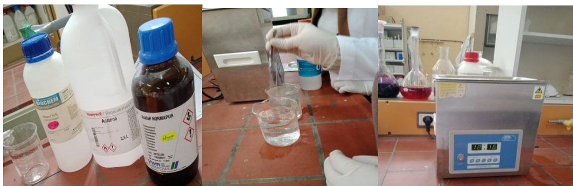
Figure. III.2 : le bain à ultrason utilisé.
