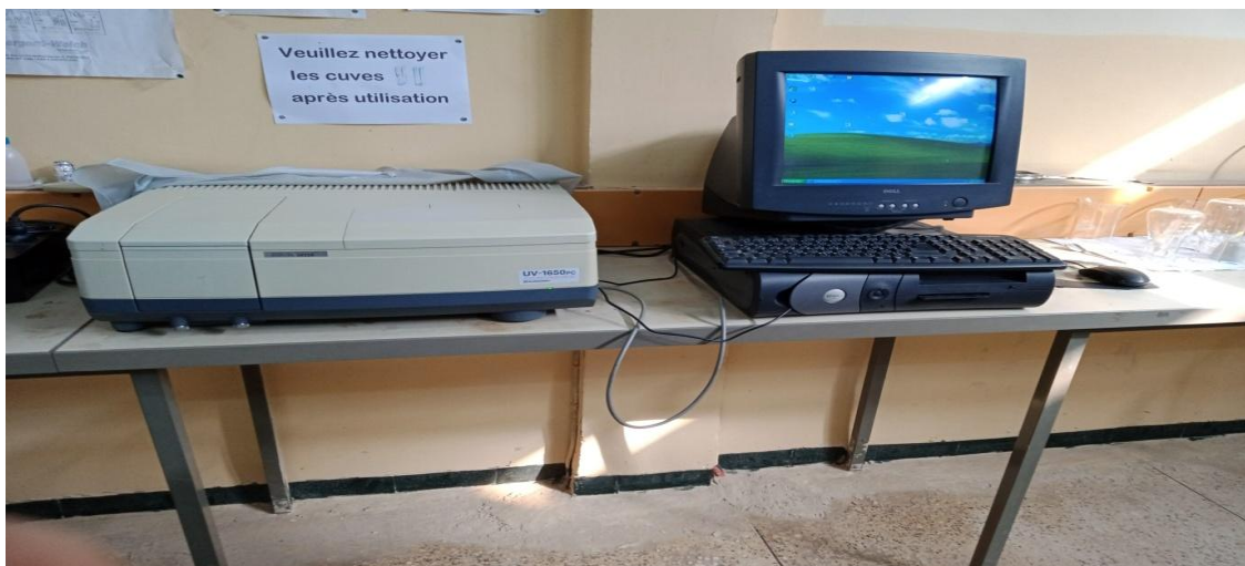
Figure. III.7 : Schéma de photomètre à double faisceau de type SHIMADZU (UVI1650PC).
