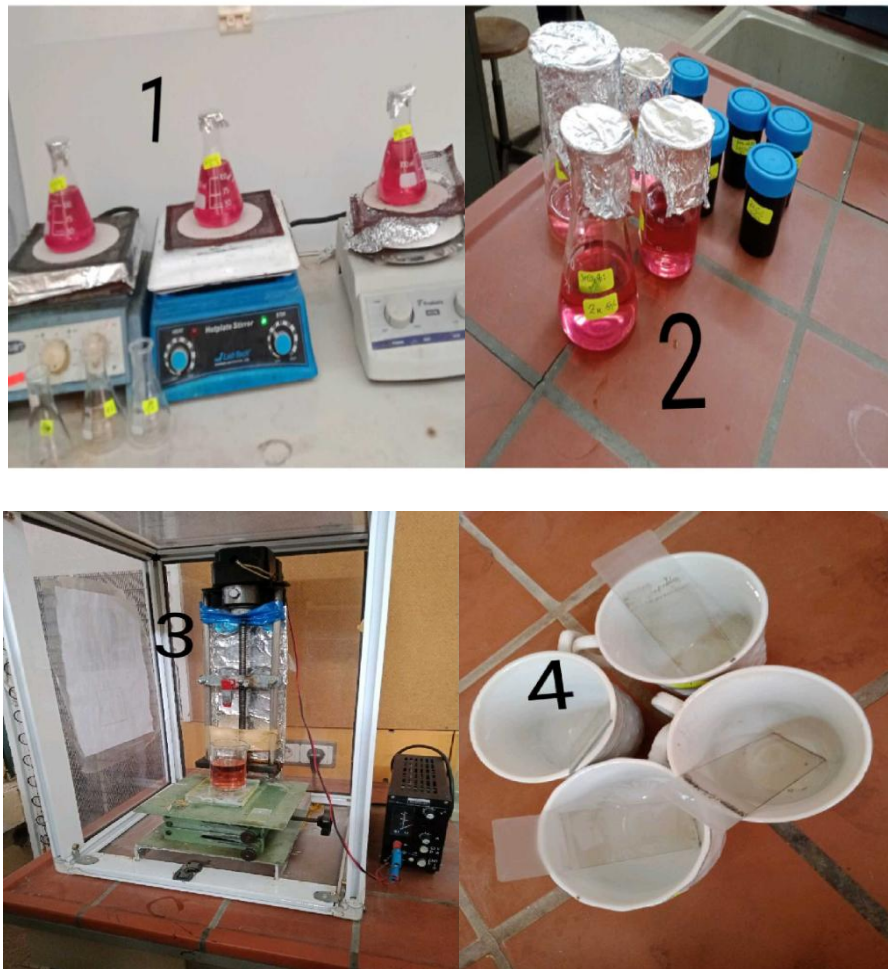
Figure. IV.4. Elaboration des couches minces de \text{SrCo}_2\text{O}_4 dopé Zn 1% ; 3% ; 5%.
