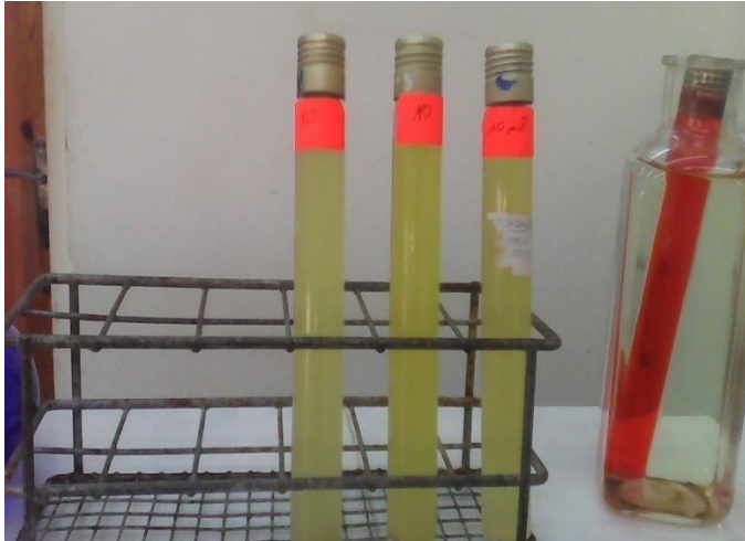
Photo n°05: Résultat de recherche de coliformes totaux à 37°C dans l'eau à analyser (BCPR D/C).
