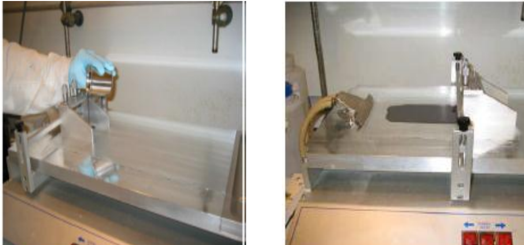
Figure II-3 : Etalement de l'encre sur une feuille d'aluminium à l'aide d'une table d'induction.
