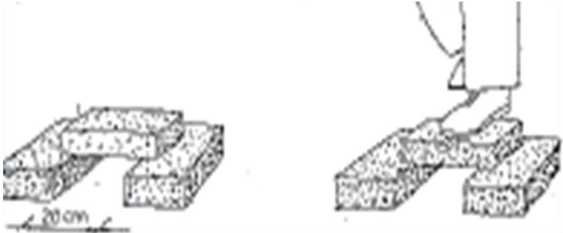
Figure 41 : L'essai de flexion d'après « CNERIB ».
