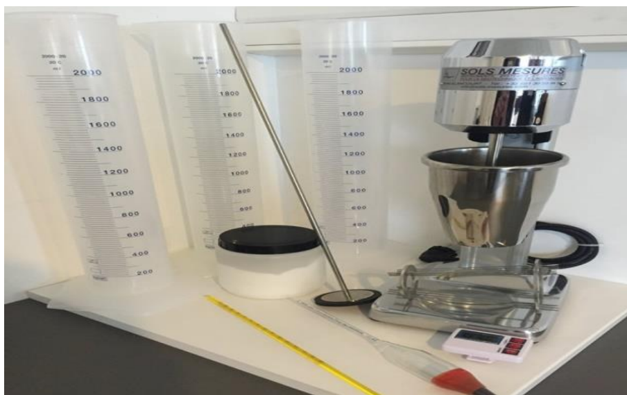
Figure 32 : Appareillage d'analyse granulométrique par sédimentométrie.
