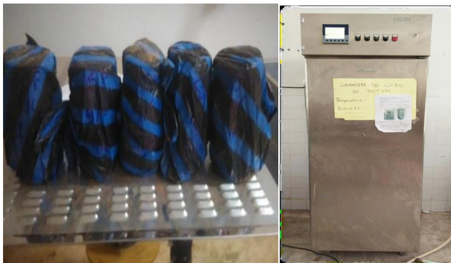
Figure 38: Conservation des blocs au laboratoire et l'étuve utilisée pour la cure.
