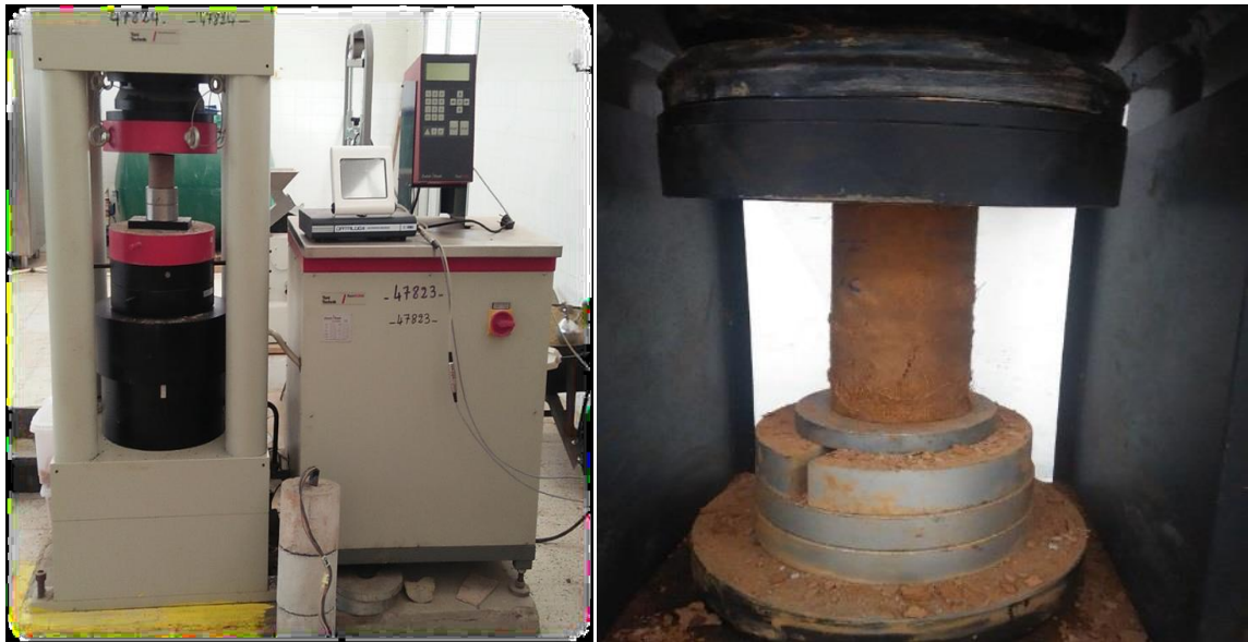
Figure 39 : Presse hydraulique pour l'essai de compression et Le bloc après écrasement.
