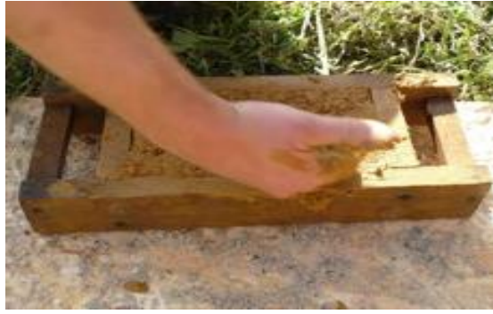
Figure 12: Mélange coulé dans des moules en bois en forme de briques et cuit au soleil.
