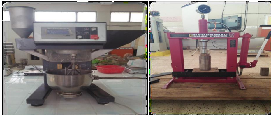
Figure 36 : Le malaxeur et l'extracteur mécanique utilisé.
