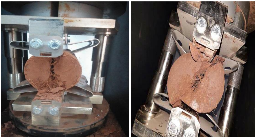
Figure 40 : l'essai de traction par fendage.
