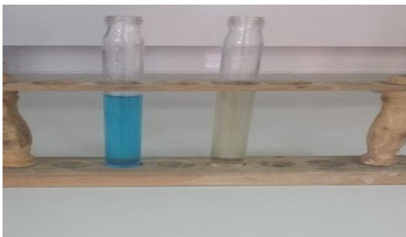
**Figure 6 :** Décoloration de la solution de BM après biosorption au pH optimum (11)
