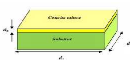
Figure I. 1: Géométrie d'une couche mince
