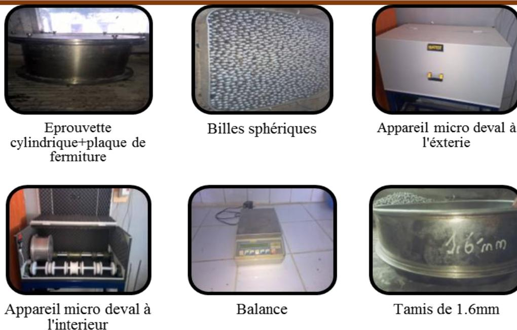
Figure (IV.17) : Matériels nécessaires pour l'essai Micro Deval
