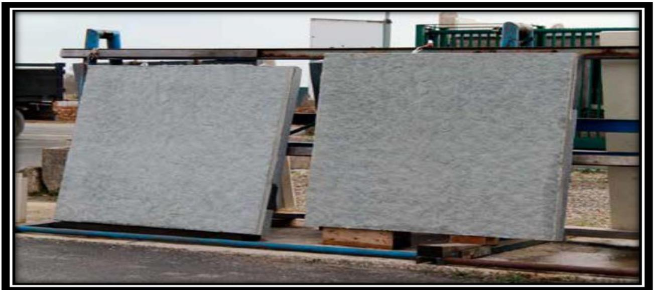
**Figure (I.13) :** Produit préfabriqué avec des GBR
