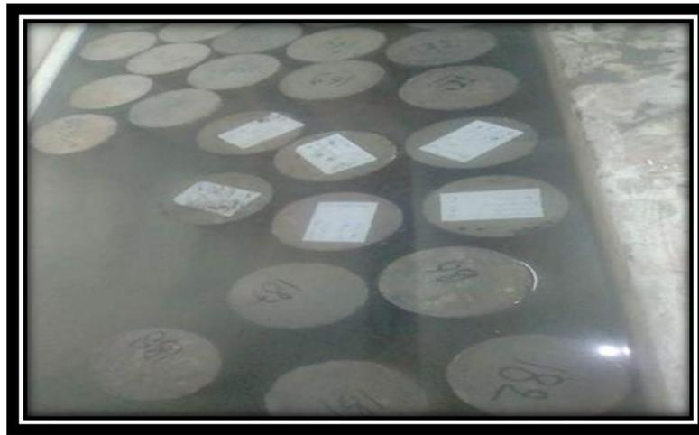
Figure (IV.27) : Conservation des éprouvettes dans l'eau à 20 C
