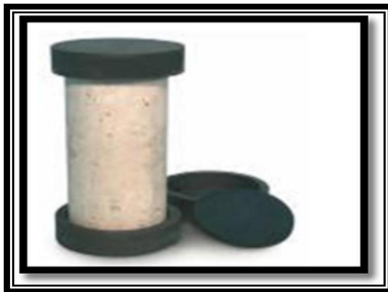
Figure (IV.28) : Disque en néoprène Ø 16 cm (surfaçage)
