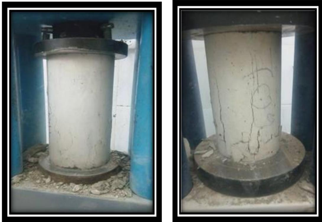
**Figure (IV.29) :** Chargement et rupture des éprouvettes
