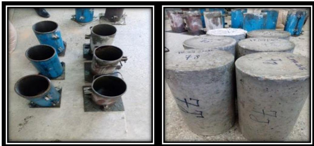
**Figure (IV.26) :** Démoulage des éprouvettes cylindriques
