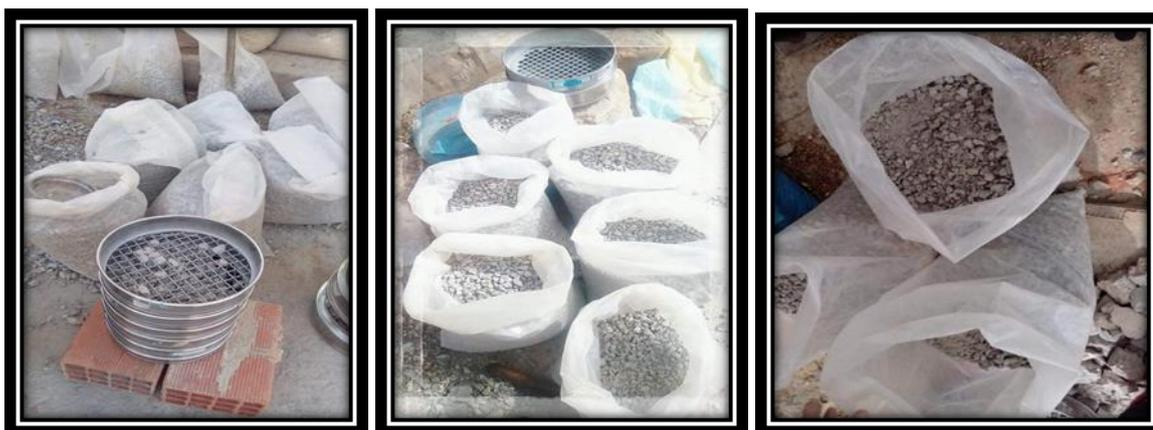
**Figure (IV.20) :** Concassage et Calibrage des Granulats Recyclés
