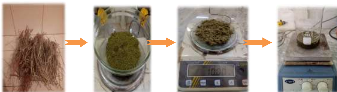
Figure 20: Etapes de préparation de l'extrait aqueux: plante séchée (a), poudre végétale (b), mélange poudre végétale + eau distillée (c) agitation magnétique du mélange (d) (Original)
