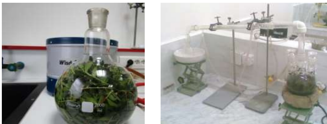
Figure 18: dispositifs expérimentaux de l'hydrodistillation (extraction de l'HE). (Original)
