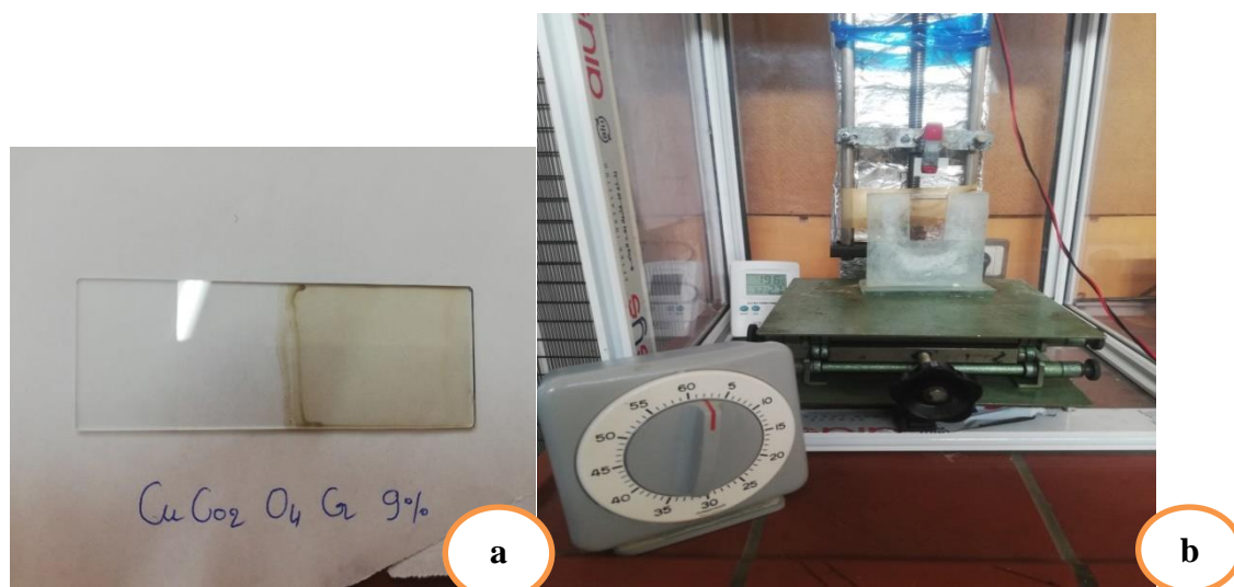
Figure III.5:(a) film mince déposé sur un substrat en verre pyrex ; (b) Dispositif expérimental de trempage- retrait (Dip-coating)
