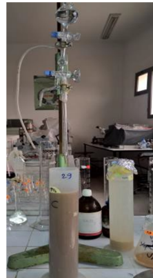
Photo N°05: Analyse granulométrique par la méthode de la pipette de Robinson.
