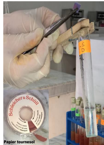
Photo N°17 : Détection des et des dénitrifiant par le papier tournesol.
