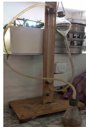
Photo N°08: mesure du calcaire total par le calcimètre de Bernard.
