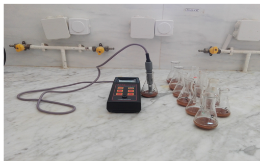
Photo N°07: mesure de la conductivité électrique du sol par le conductivimètre.
