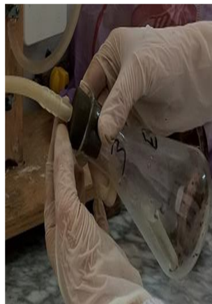
Photo N°08: mesure du calcaire total par le calcimètre de Bernard.
