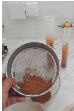
Photo N°05: Analyse granulométrique par la méthode de la pipette de Robinson.
