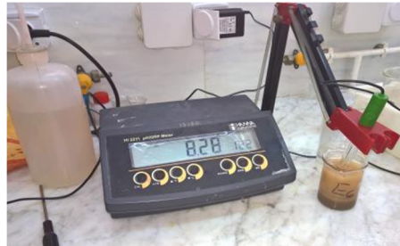
Photo N°06: mesure du pH d'un échantillon de sol à l'aide d'un pH mètre.
