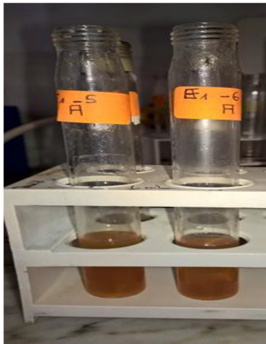
Photo N°16 : détection de la présence des ammonifiantes par le réactif de Nessler.
