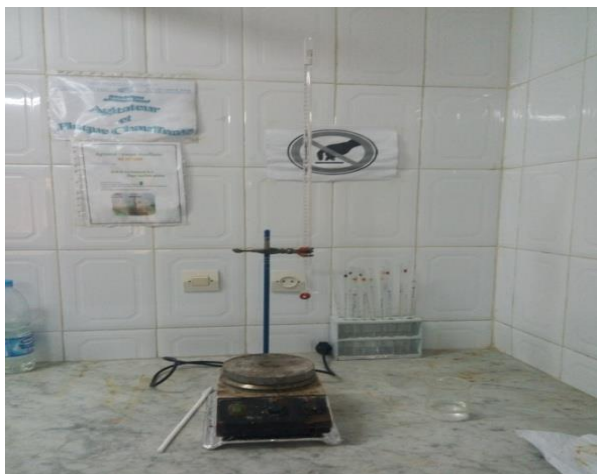
Agitateur + plaque chauffante.
