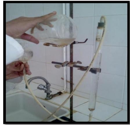
**Photo n° 07** : Mesure de calcaire total (06-04-2017).
