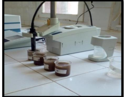
**Photo n° 06** : Conductimètre (05-04-2017).
