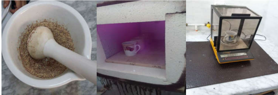
Figure 21 : Broyage, incinération des échantillons et récupération des cendres.
