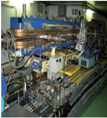
la cavité radiofréquence du booster de soleil
