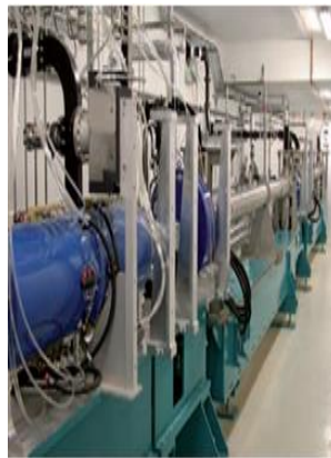
un aimant de courbure de l'anneau de stockage de l'ESRF
