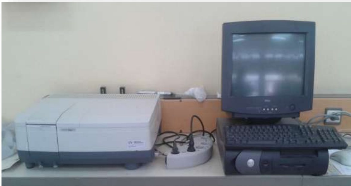
Figure II.7: Schéma de spectro photomètre à double faisceau de type SHIMADZU (UV 1650 PC).
