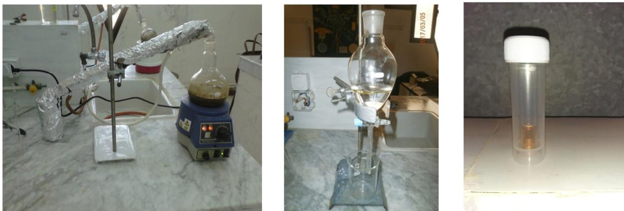
**Fig 14:** le montage de l'hydro distillation au niveau de laboratoire (original)
