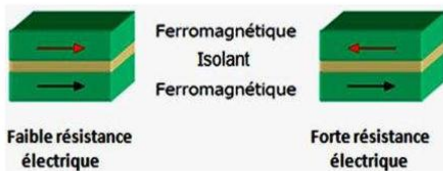
Figure I.12: les deux états, parallèle et antiparallèle, dans une jonction tunnel magnétique.
