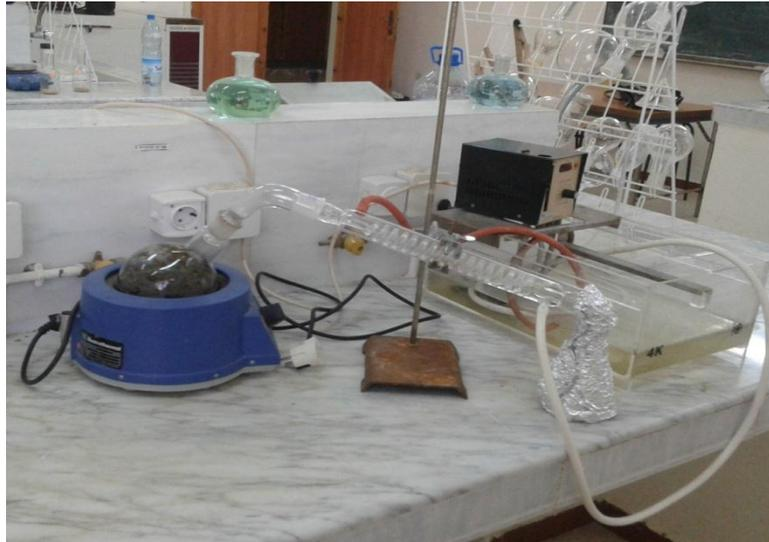
**Figure 06:** Montage de l'hydrodistillateur
