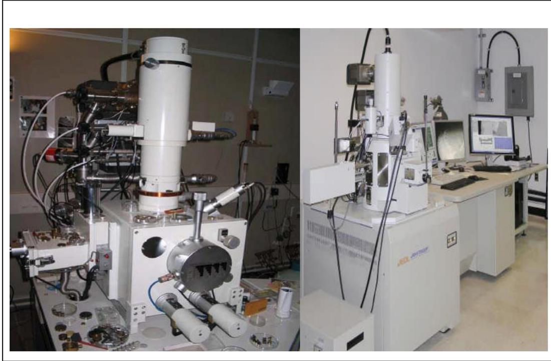
Figure II-9 Images du microscope électronique à balayage (MEB), (a) un JEOL type JSM 6400F, (b) JEOL 7600v
