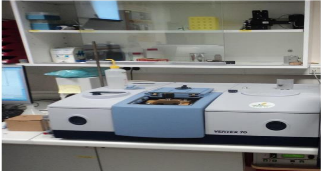
Figure (II.04) : Un spectromètre FTIR-ATR Vertex70-RAM II Bruker (Bruker analytique, Madison, WI).
