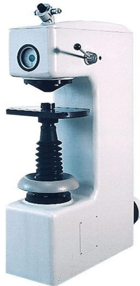
Fig. IV.2 : Duromètre utilisé pour mesurer la dureté Rockwell
