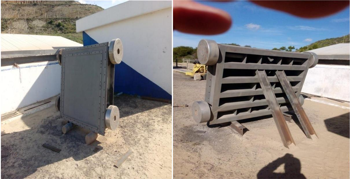
**Figure II.16 :** Vanne après nettoyage par le sable.
