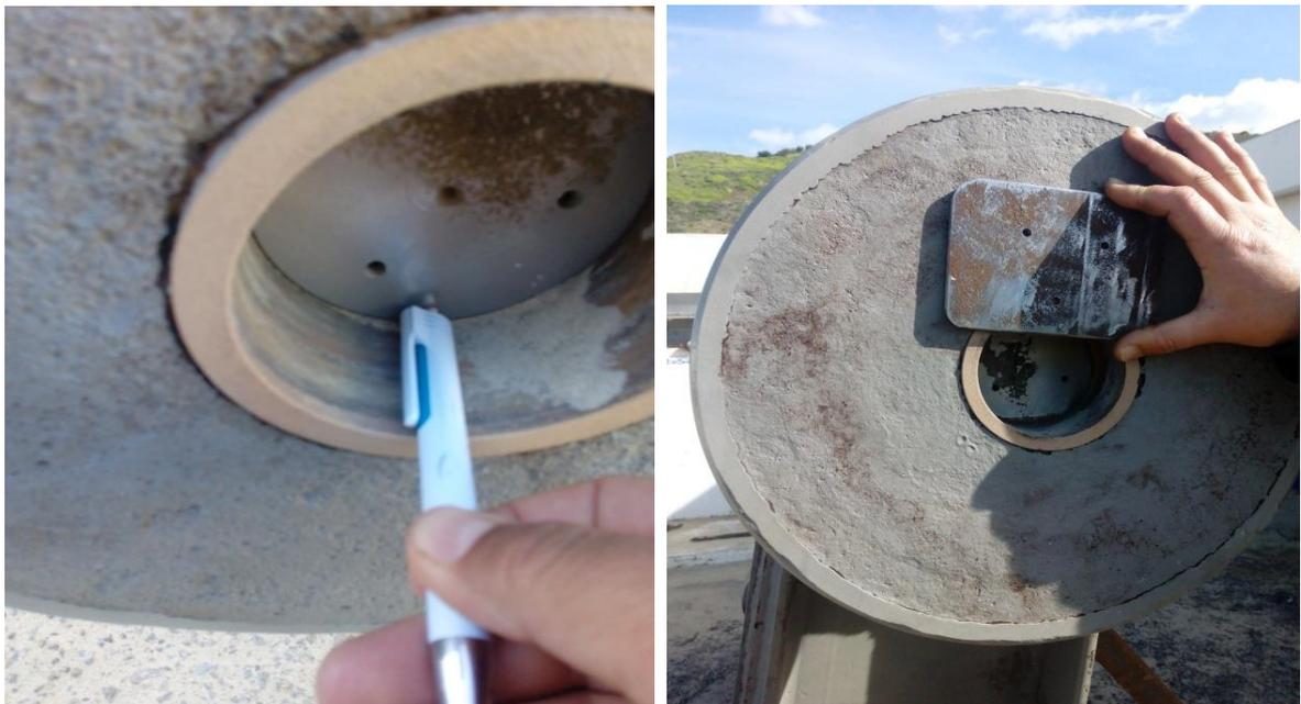
**Figure II.17 :** Anomalie (décalage des roues).
