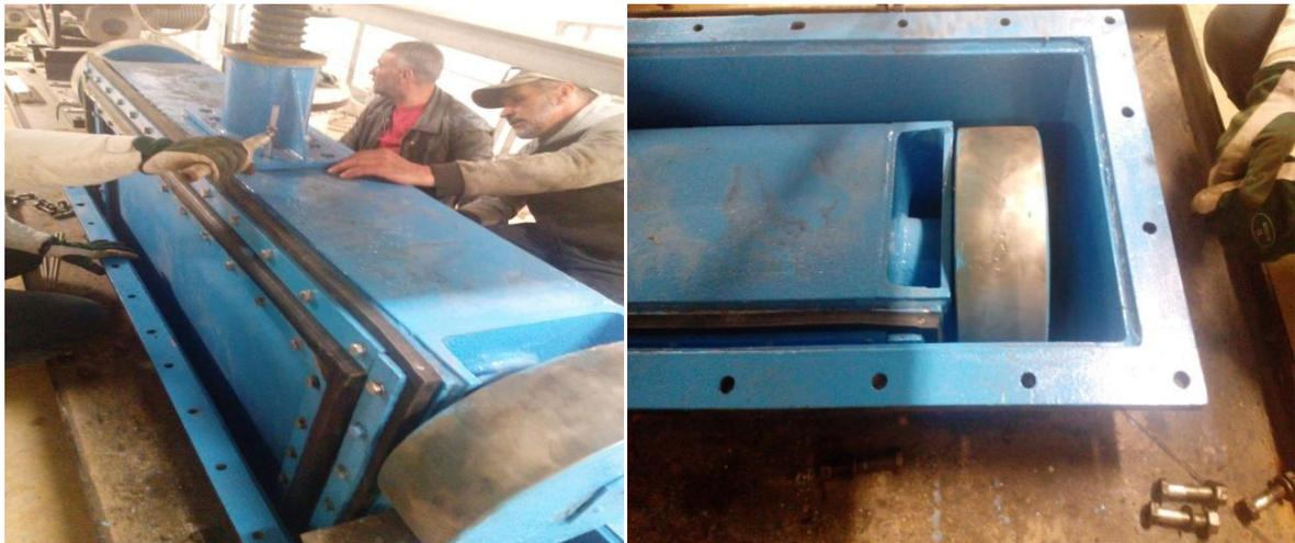
**Figure II.19 :** Remise en place de la vanne.
