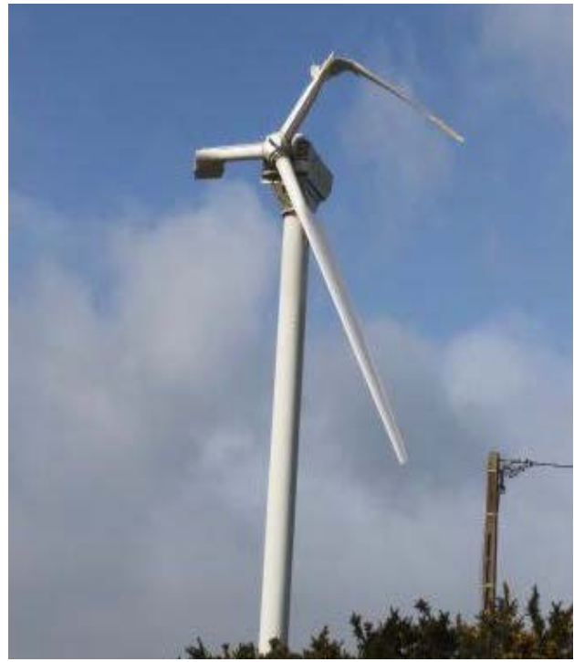
b) Pales brisées par un coup de vent en Le février 2016 à Dinéault, dans le Finistère. à Uedem, en Belgique.
