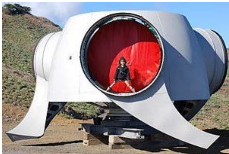
Figure I.9 : Moyeu sur lequel les pales ont été fixées.
