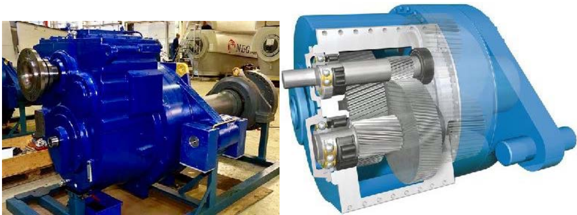
Figure I.11 : Multiplicateur et son schéma de fonctionnement.
