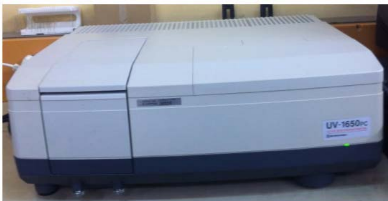
Figure III-2: Spectrophotomètre UV-Visible de marque SHIMADZU UV-1650-PC à double faisceau.
