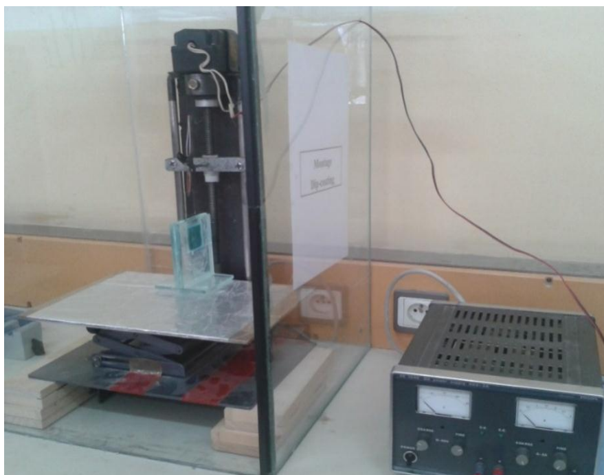
Figure IV.6: Dispositif expérimental de trempage – tirage (Dip-coating).
