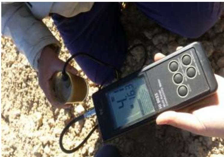
Fig n° 07 : La Mesure de CE sur terrain
