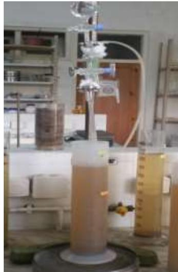
Fig n°12 : pipette de robinson (granulométrie)
