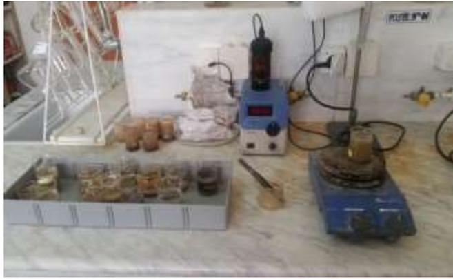
Figure n 14 : préparation pour mesurer la CE
