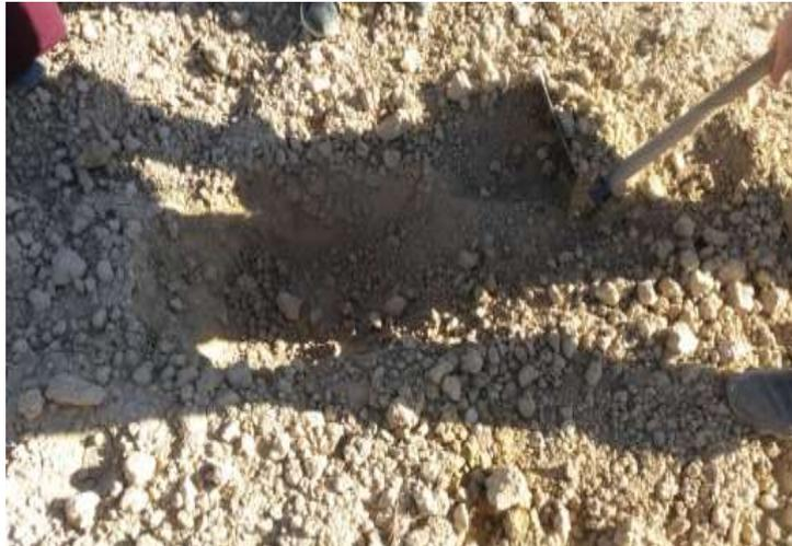
Fig n° 06 : Prélèvement de l'échantillon de sol
