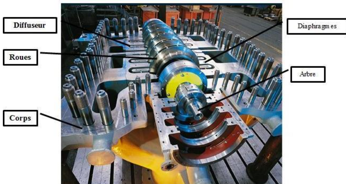
Fig I. 11. Compresseur 9H-7B Section BP
