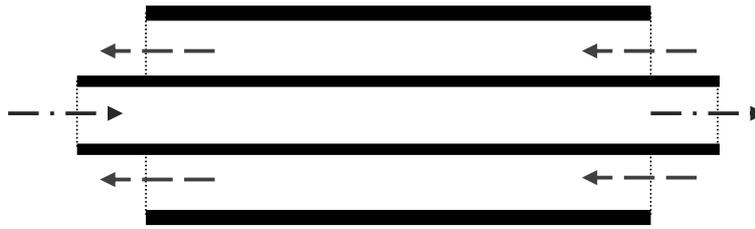
*Figure I.4 : Exemple d'échangeur tubulaire.*
