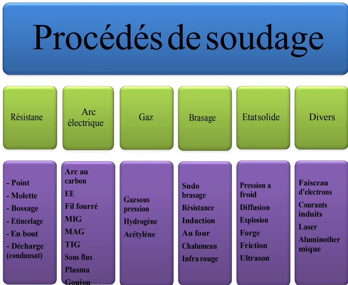
Figure 1-4 Classification des procédés de soudage en fonction de l'énergie utilisée [4].
