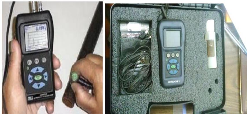
**Fig. II.8.** Prise d'épaisseur par un appareil de CND : Ultrasons.
