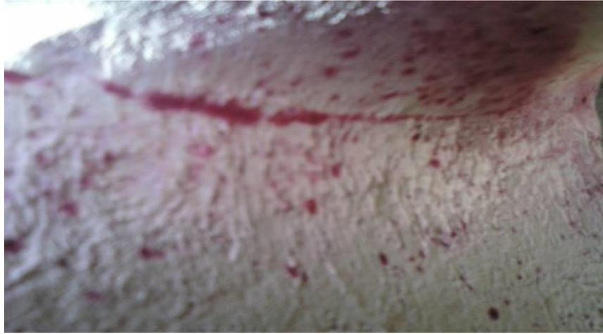
**Fig. III.3.** Photo de la fissure avant meulage.
