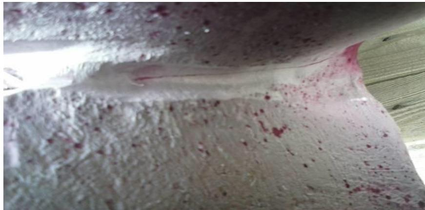
**Fig.III.4.** Photo de la fissure après le meulage.
