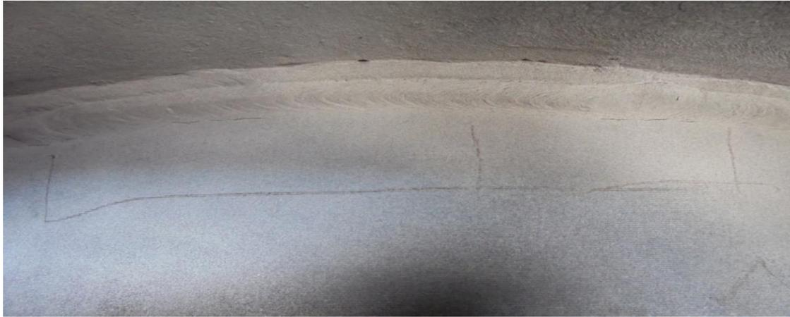
**Fig.III.7.** Photo de fissure après le contrôle magnétoscopie
