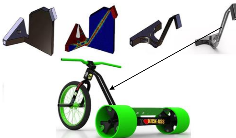
Figure 1.7 : Optimisation topologique d'un drift trick.
