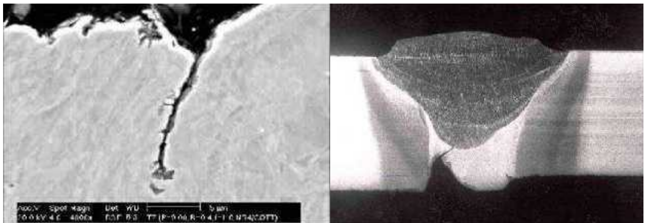
Figure 2.11 : Fissure dans des joints soudés.
