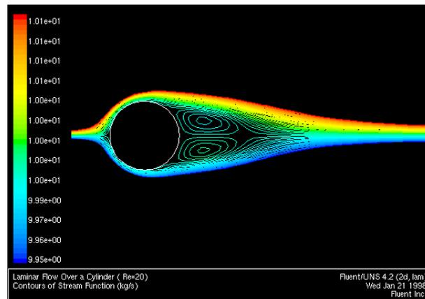
**Figure I.11** : La zone de recirculation d'un fluide laminaire autour un cylindre [13]
