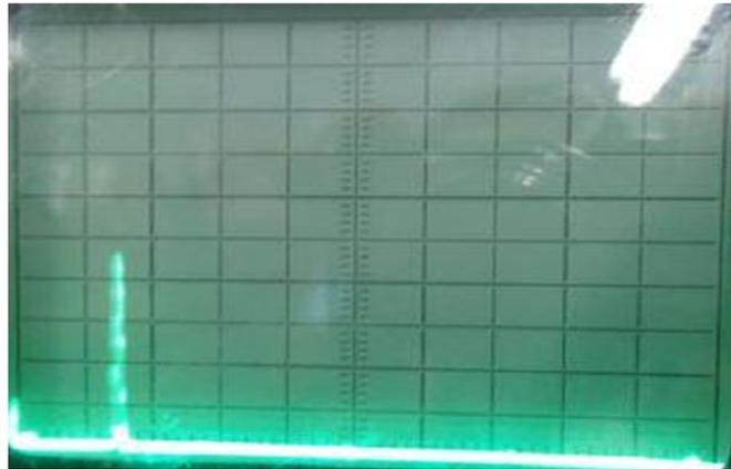
**Figure III.13** : Résultat de la recherche de l'entaille sur la cale
