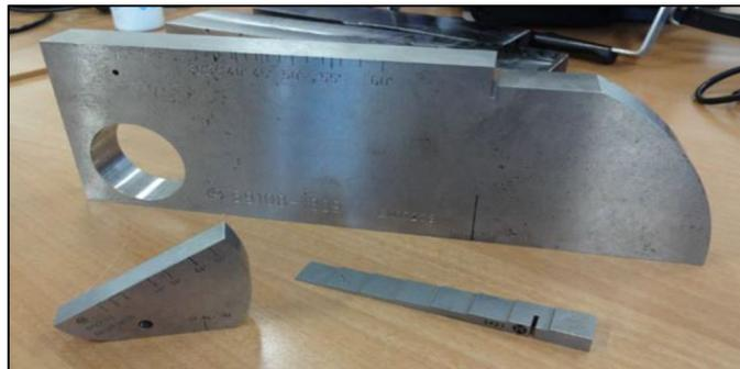
**Figure III.2 :** Les différents types des cales d'étalons
