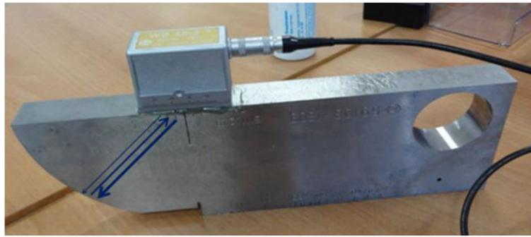
**Figure III.3 :** Etalonnage de l'appareil à ultrasons
