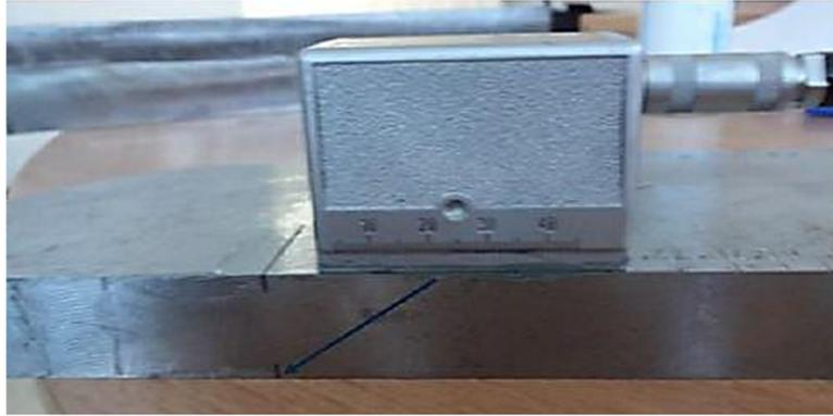
**Figure III.12** : Recherche de l'entaille sur la cale
